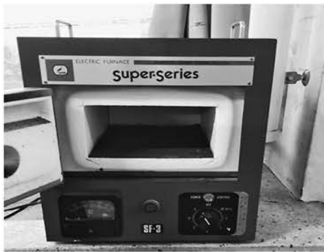
1. 焼成実験に用いた電気炉
