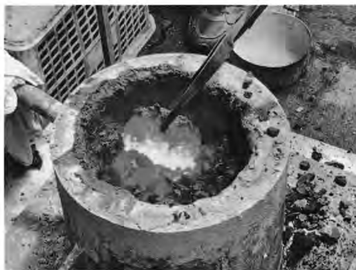
卸し鉄実験の様子。溶解した鉄塊を平箸で炉底から取り出す。
