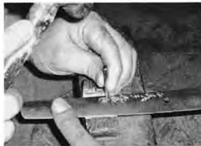
左：茎の美観を整えるヤスリ目 右：タガネを使った銘切 ともに刀匠の仕事
