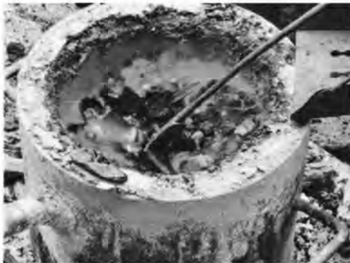
炉底から溶解した鉄を取り出す
