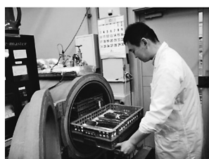
⑤ 凍結乾燥を用いた残存水分の除去
